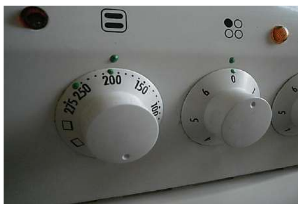
Figura 15: Questa immagine mostra il pannello di controllo di un forno da cucina. La manopola è contrassegnata in modo da poter determinare un punto di riferimento al tatto. È importante stabilire un punto di riferimento rispetto alla marcatura, è necessario segnare un punto di partenza sul dispositivo su cui viene regolato il pulsante contrassegnato.
